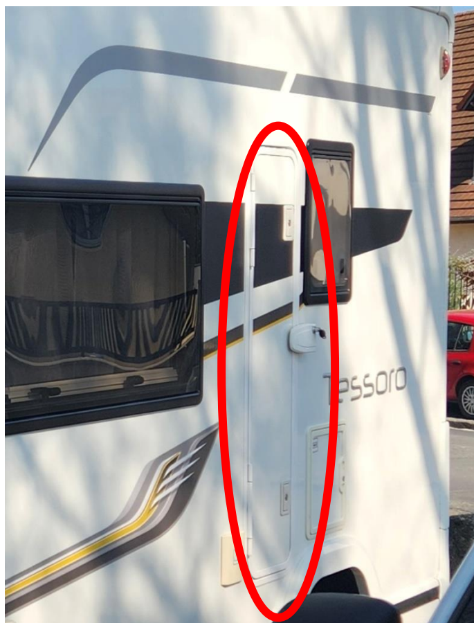
Circuit sale : le placard poubelle DASRI et DAOM s'ouvre aussi de l'extérieur afin d'évacuer les sacs en fin de service sans passage par l'intérieur du véhicule
